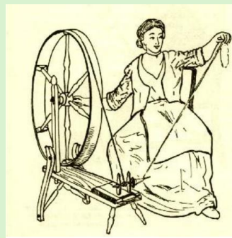
Filage de la laine à la quenouille et au rouet.
